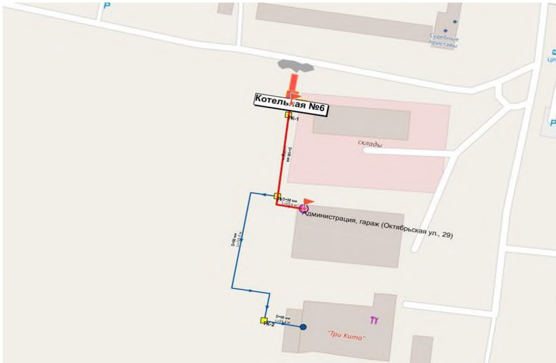
Рисунок 3.9-13 – Участок от котельной №6 до ТК-1а для построения пьезометрического графика
