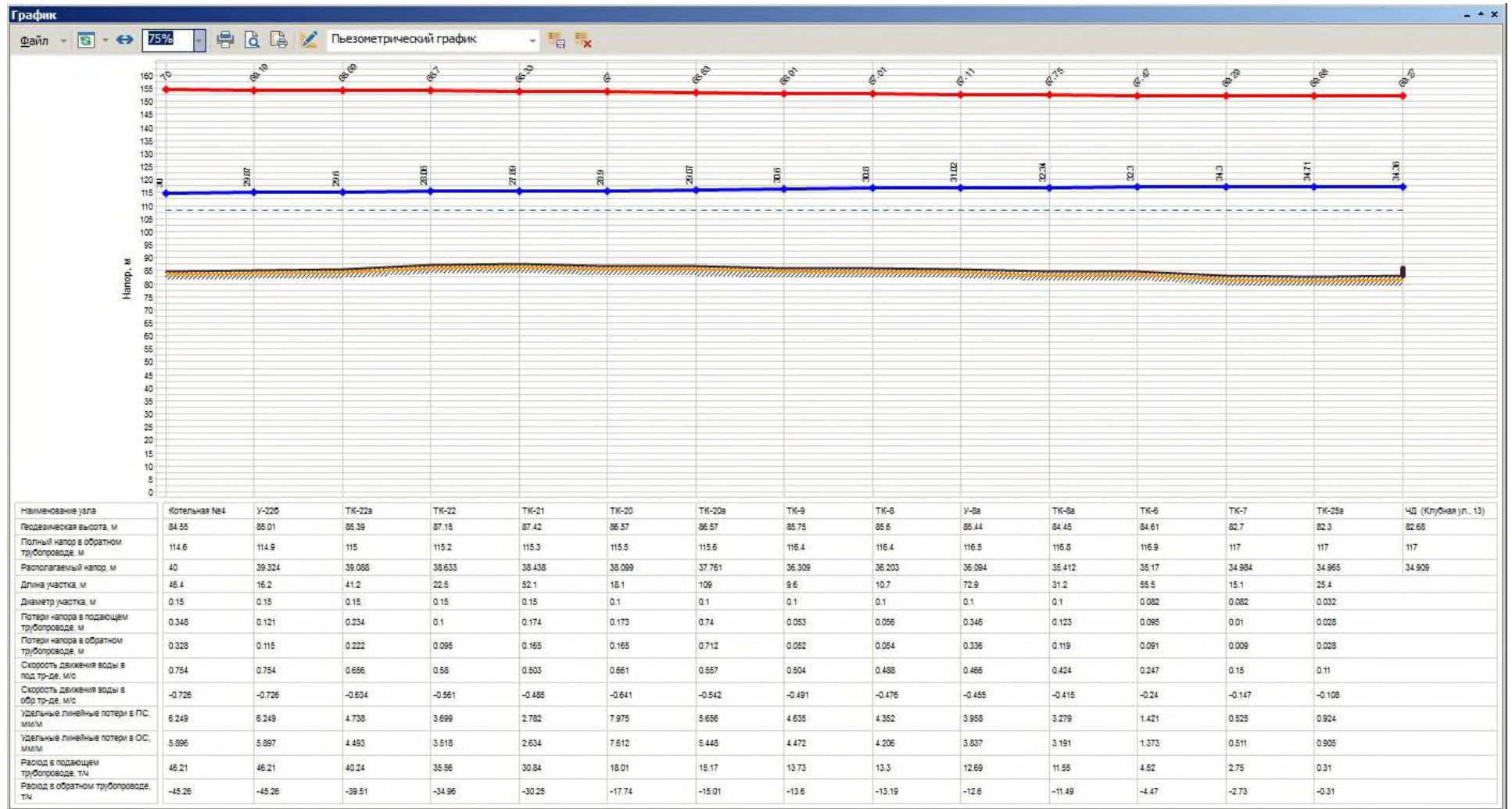
Рисунок 3.9-12 –Пьезометрический график участка № 2 котельной № 4 до ТК-25а
