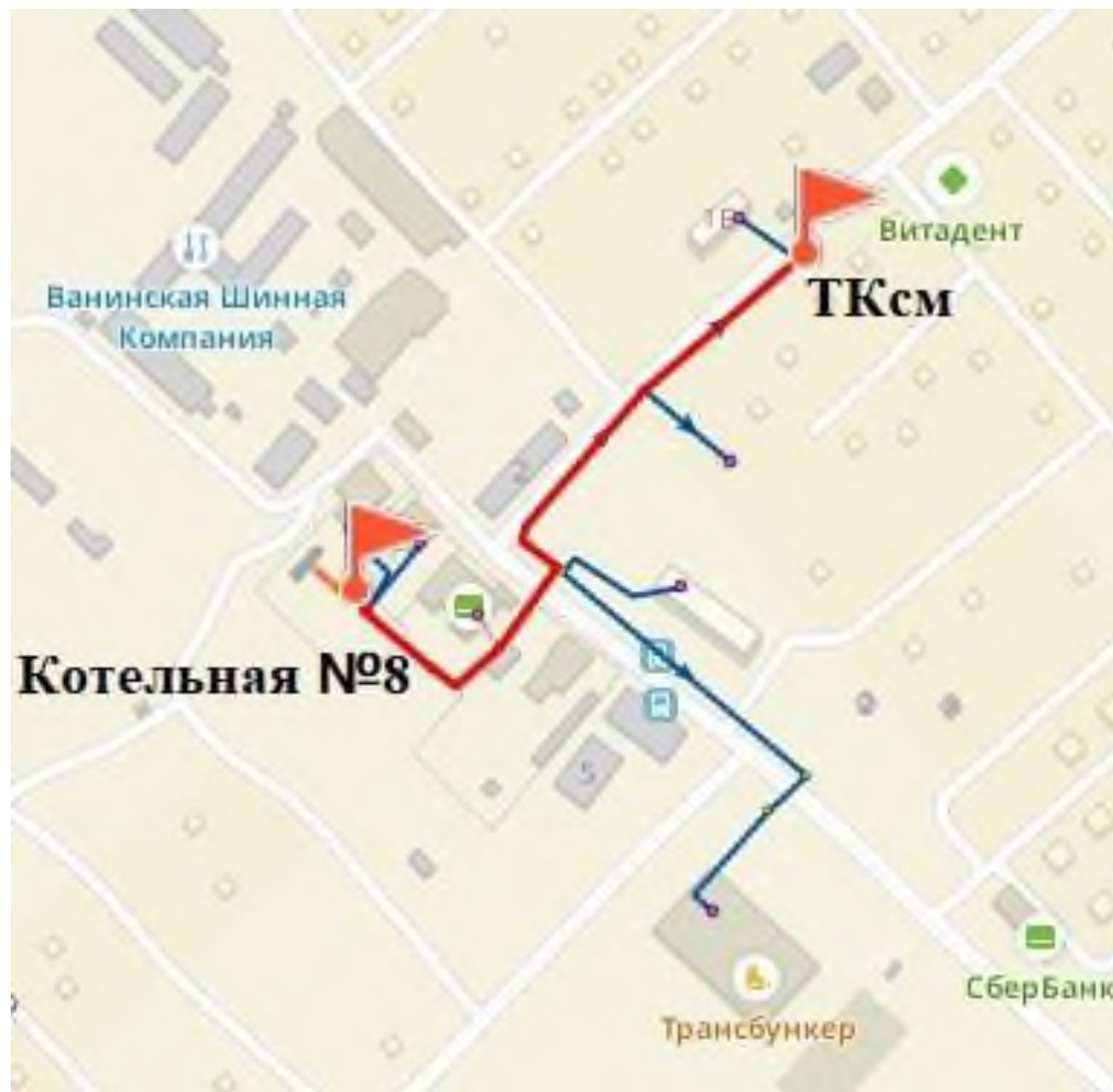
Рисунок 3.9-21 – Участок от котельной №8 до ТКсм для построения пьезометрического графика
