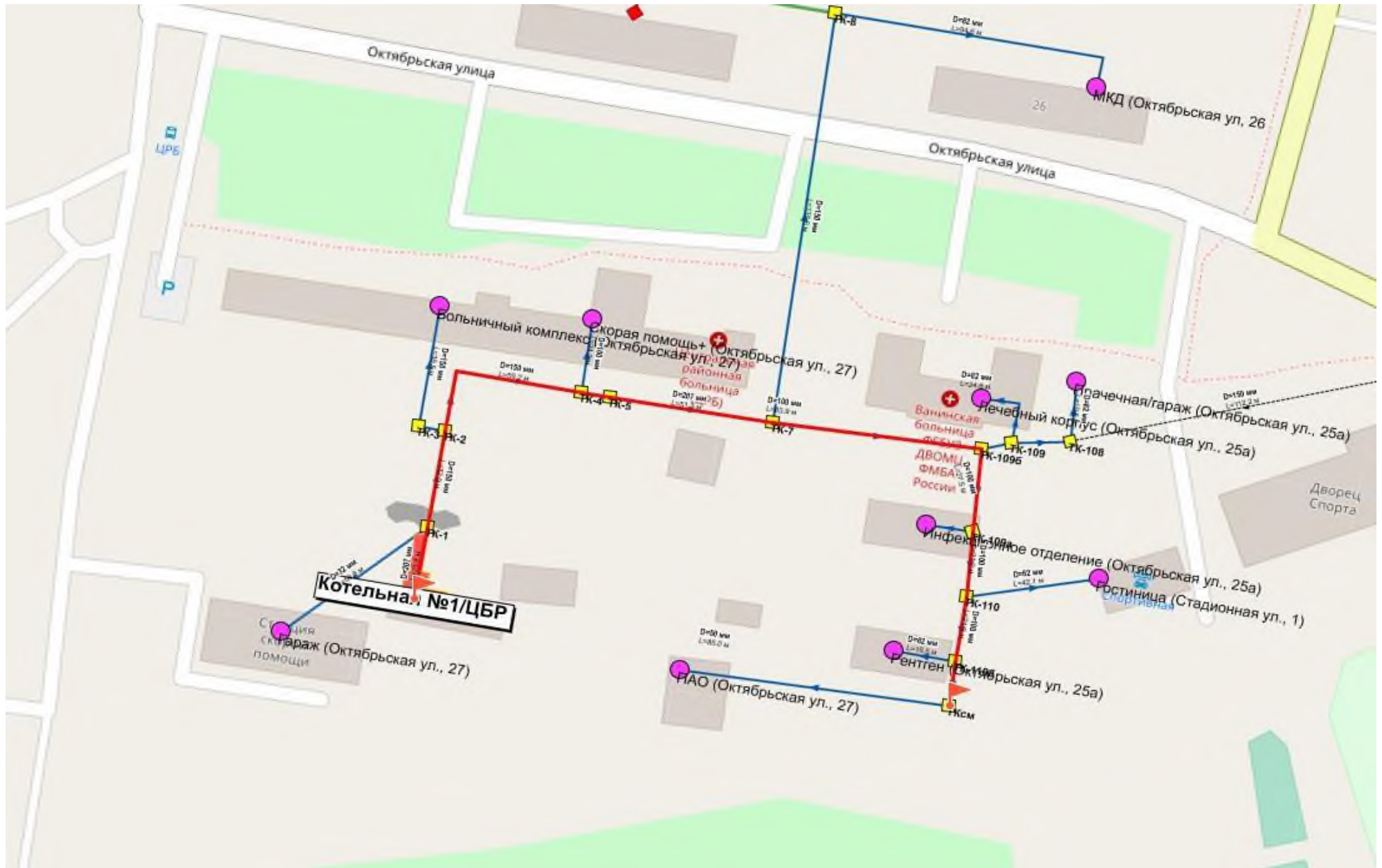
Рисунок 3.9-7 – Участок от котельной №1 до ТК-110а для построения пьезометрического графика
