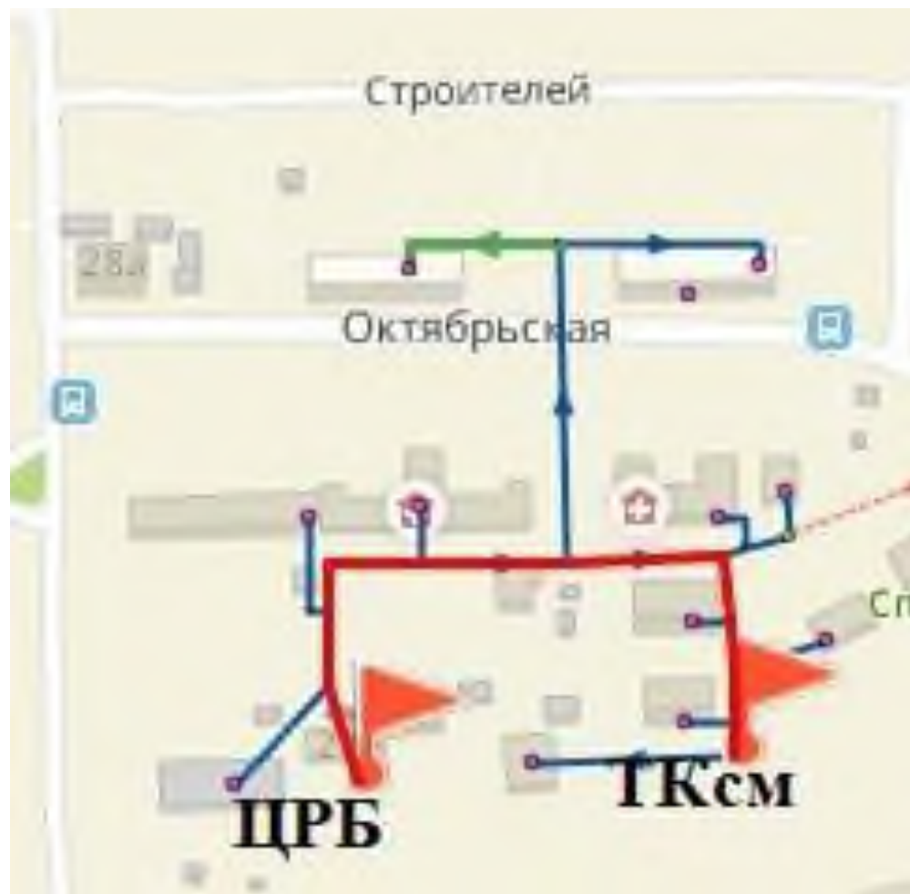
Рисунок 3.9-25 – Участок ЦРБ до ТКсм для построения пьезометрического графика
